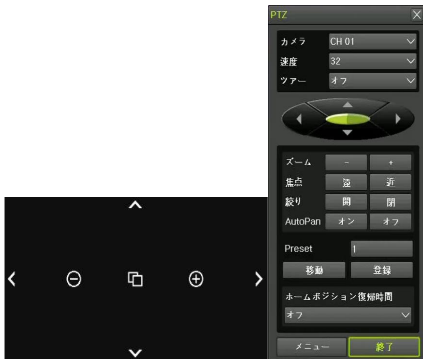
[図 2-11. PTZコントロール]
