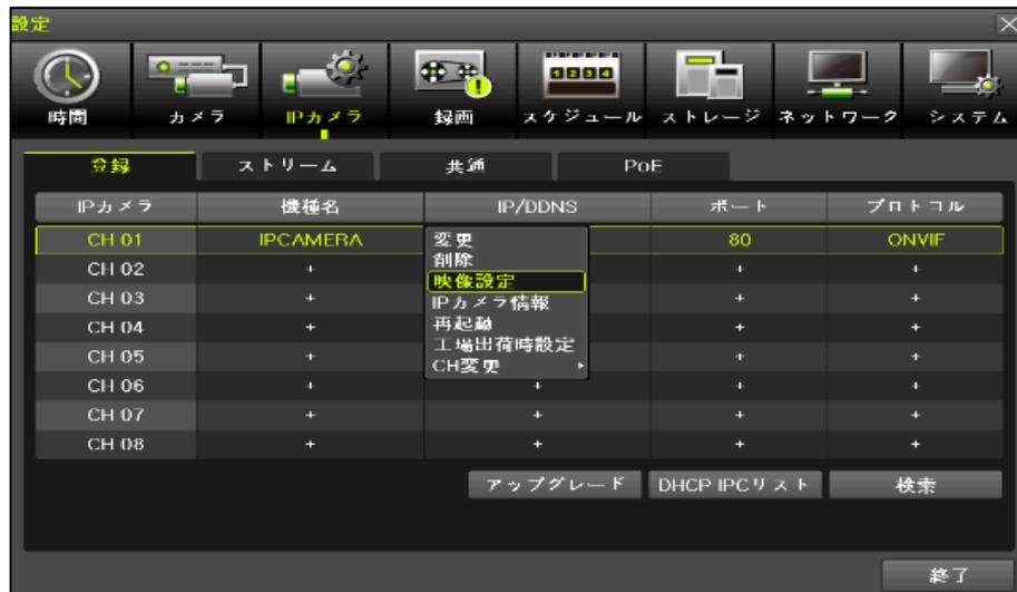
[図 3-13. IPカメラ映像設定]
