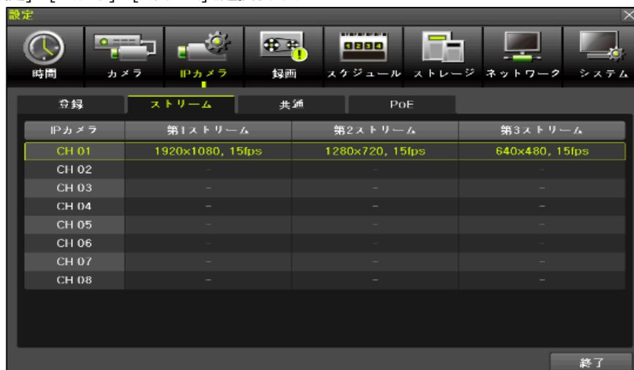
[図 3-15. IP カメラストリーム設定]
