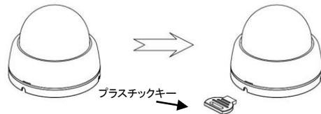
※ プラスチックキーをドームカメラ底部の溝に差し込んでひねると外れます。
