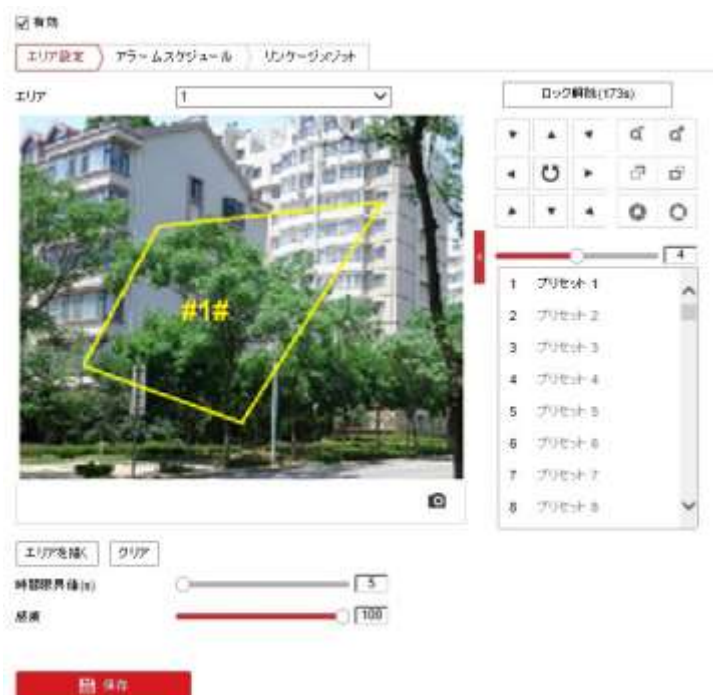
図 5-29 放置手荷物検知の設定
