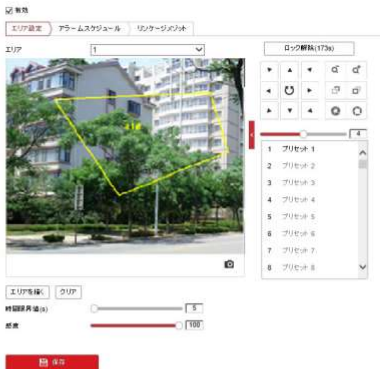
図 5-28 放置手荷物検知の設定
