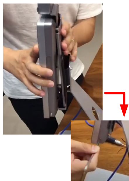
③本体とプレートの固定
