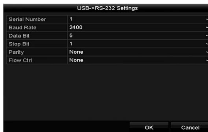
図9.5 USB から RS-232 への設定
