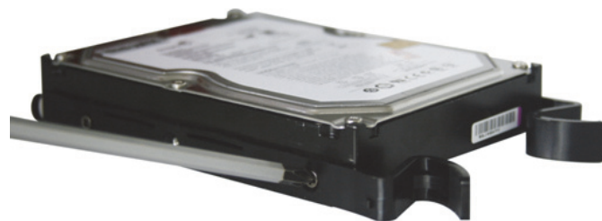
図 2-1 ハードディスク固定
