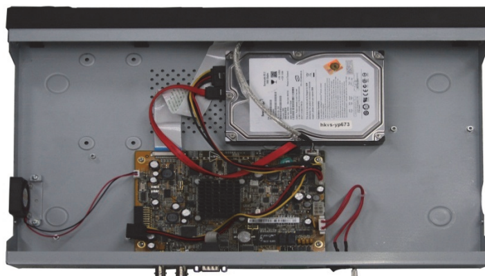
図 2-9 ハードディスクの固定
