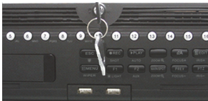
図 2-2 パネルキーの挿入
