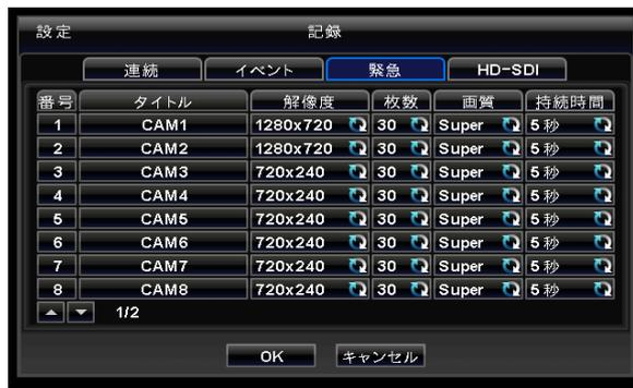
\* `解像度` : 各チャンネルの録画解像度を選択します。1920x1080, 1280x720, 720x480(576), 720x240(288), 360x240(NTSC) の内、一つのモードを選択できます
