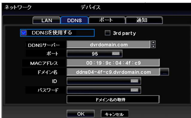
\* DHCPはアクセスする度にアドレスが変わります。 IPアドレス代わりに ドメイン名を使用するDDNS(Dynamic Domain Naming System)があります。 DDNSは自動的にIPアドレスの変更などを認識するためインターネットアクセスができます。
