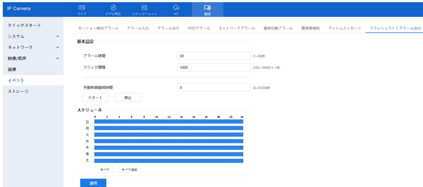
図 7-11 ストロボライトアラーム出力設定画面
