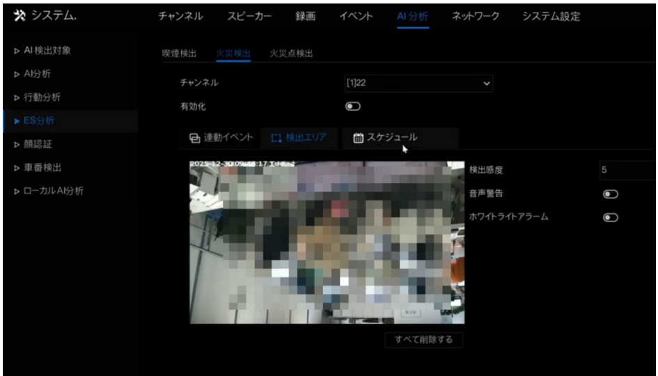
図 6-61 煙火検知 — 検知領域設定画面
