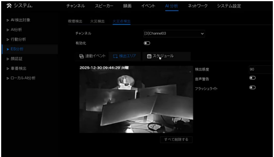
図 6-64 火点検知 — 検知領域設定画面
