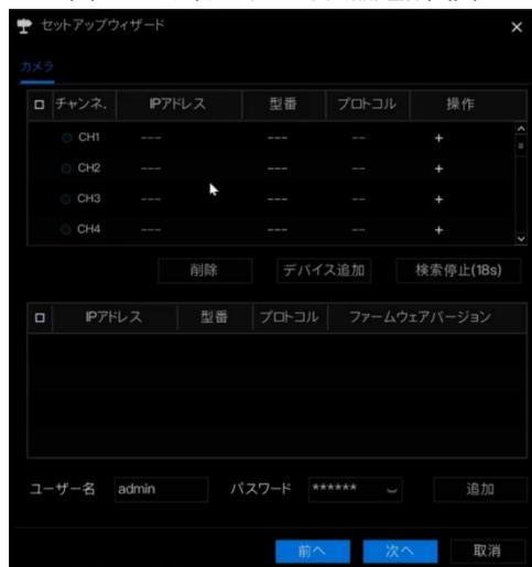
図 4-12 ウィザードによる機器追加画面
