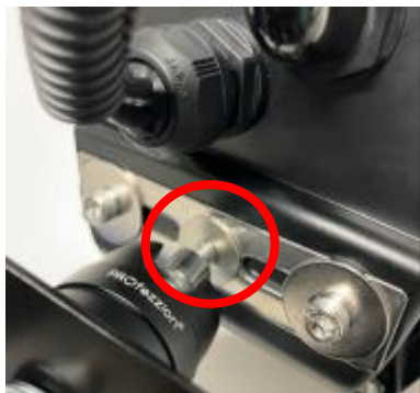
ボールジョイントと本機 接続部が緩んだ状態
