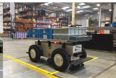
所定位置まで自律走行モードで移動して待機、オペレーターが協働走行モードと一緒に搬送業務へ
