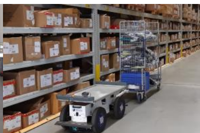
自律走行モードによるトレーラー牽引
