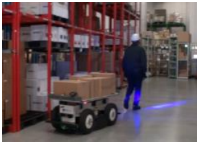
EffiBOT本体で走行エリアを スキャンし地図を生成
