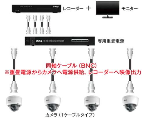
※IPカメラの場合：同軸ケーブル→LANケーブル
